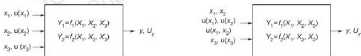
Рисунок 2 — Обобщенный закон трансформирования неопределенностей для N = 3 взаимно независимых величин X_1 , X_2 и X_3 и m = 2 взаимно зависимых выходных величин (слева) и тот же закон, но для взаимно зависимых X_1 и X_2 (справа)
