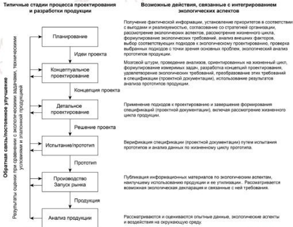
Рисунок 2 — Пример общей модели интегрирования экологических аспектов в процесс проектирования и разработки продукции
