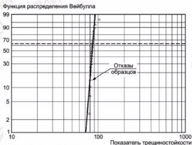
Рисунок Н.1 — Испытания на разрыв стальной пластины
