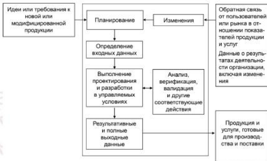
Рисунок 3 — Упрощенная диаграмма процесса проектирования и разработки и взаимосвязь анализа, верификации и валидации в рамках этого процесса
